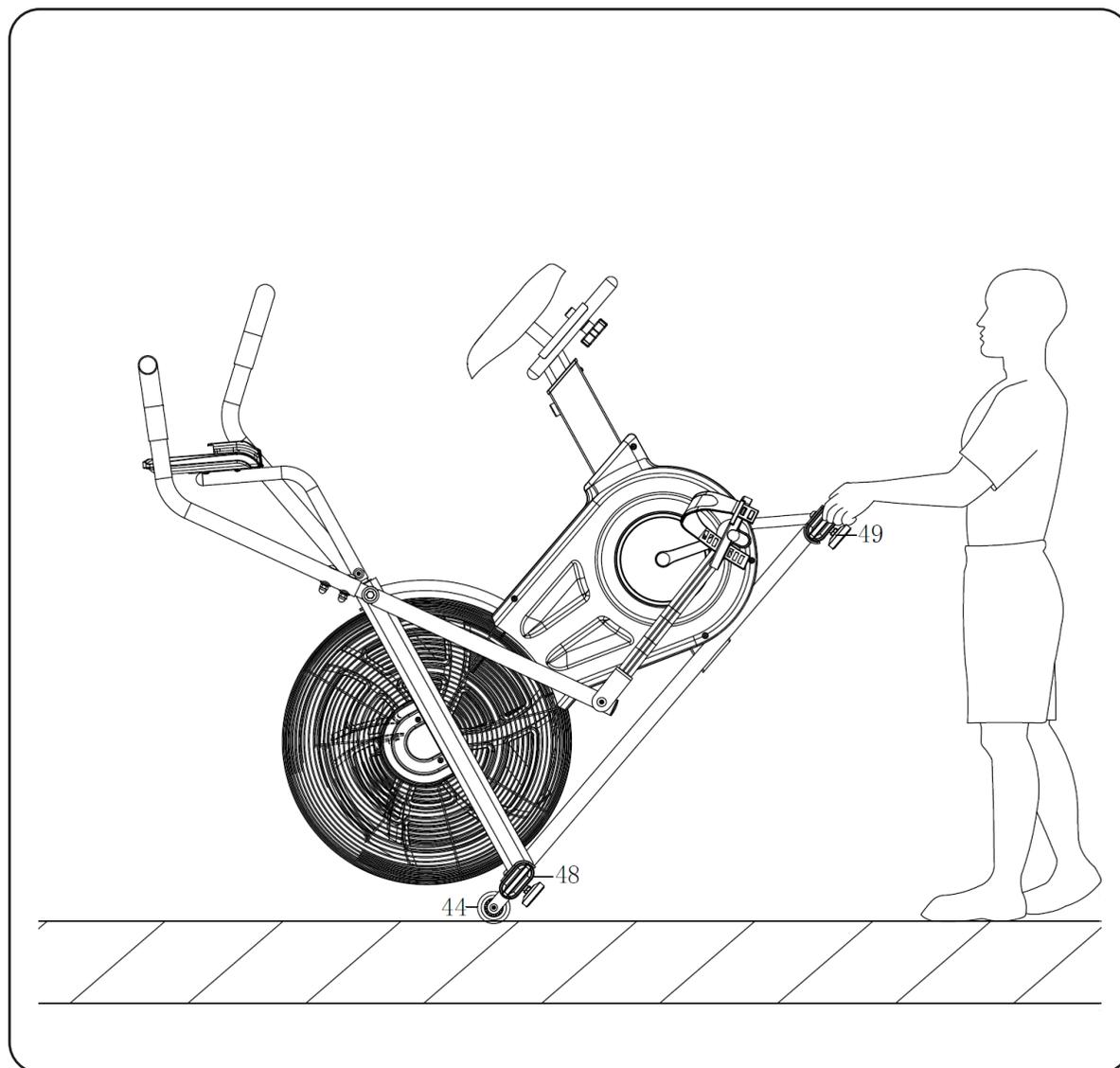
Чтобы переместить тренажер, поднимите заднюю поперечную опору (49) до тех пор, пока транспортировочные колеса (44) передней поперечной опоры (48) не коснутся земли.
